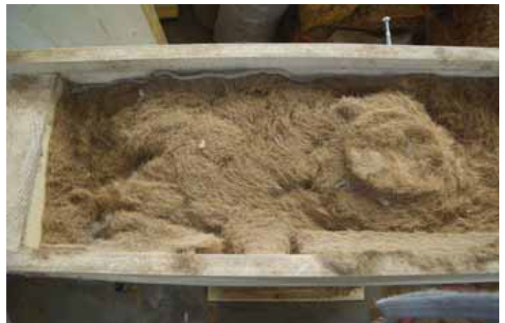
Mångsidig isolering: materialtest med tång
